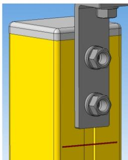
4.1. Медленно аккуратно перемещайте приёмник (или излучатель) вдоль оси крепления до положения, при котором на приёмнике гаснет зелёный и загорается красный индикатор. Поставить метку маркером на продольной части кронштейна.
