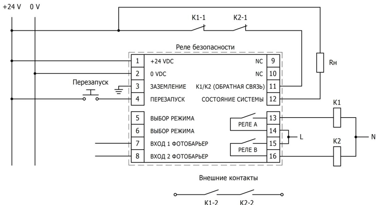
**Схема подключения внешних контакторов K1 и K2 (автоматический режим):**
