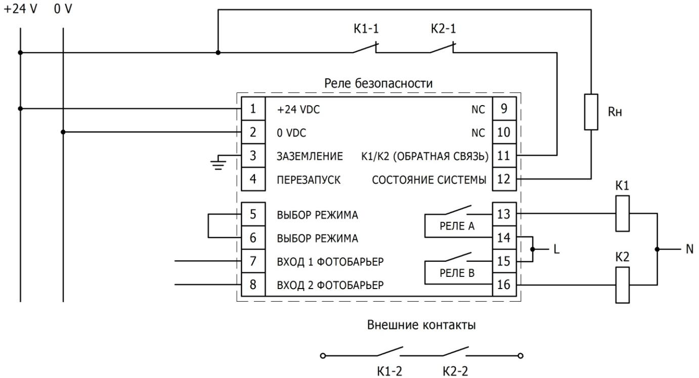
Сигнал на клемме 12 "СОСТОЯНИЕ СИСТЕМЫ" информирует о состоянии УБПВ:
